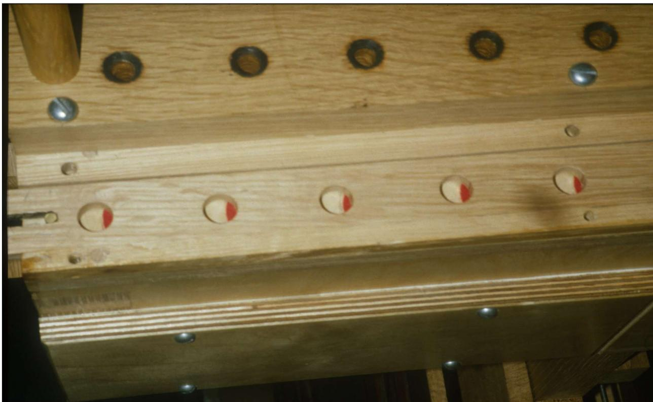
Figure 27. Photographie montrant 2 registres fermés : la couleur orange est déposée sur la face supérieure du registre en bas de l'image .
