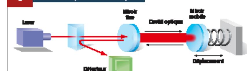
CE SYSTÈME, appelé « cavité optomécanique », comprend deux miroirs, l'un fixe et l'autre mobile. Pour certaines fréquences du rayonnement laser, la lumière s'accumule entre ces deux miroirs. Cette amplification permet d'étudier les effets de la force de pression qu'exerce la lumière sur le miroir mobile : on peut mesurer le mouvement de ce miroir avec une grande précision, et le contrôler grâce aux variations d'intensité de la force lumineuse.
